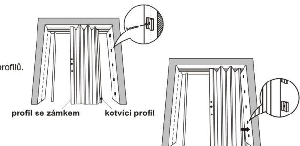
6. Zasuňte západku zámku (H) do bočního profilu (K). Šrouby (F) připevněte boční profil (K) a šrouby (E) připevněte západku zámku (H) do stejné výšky, jakou má otvor zámku ve dveřích.
