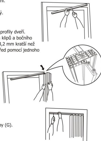
2. Vytoče horní vodící profil a nasadte shrnovací dveře (A), tak aby vám vyhovoval směr zavírání dveří. Zkontrolujte, zda všechny jezdce dveří jsou ve stejném směru.
